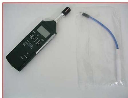
**Figure 1.** Thermo-hygrometer equipped with a vaginal sterile probe (Tecnolab del Lago maggiore S.r.l., Italy).
